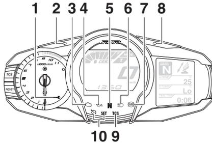
1. Anzeigeleuchte des Wegfahrsperrsystems "→"
