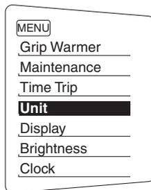
2. Den Menü-Wahlknopf "MENU" drücken. Die Einheiten-Einstellung wird angezeigt und in der Anzeige blinkt "km or mile" (nur für UK) oder "km/L or L/100km" (außer für UK).
