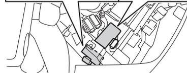
1. Sicherung des ABS-Motors
