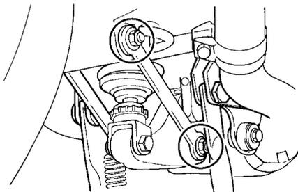
Die Drehpunkte der Hinterradaufhängung sollten in den empfohlenen Abständen in einer Yamaha-Fachwerkstatt gemäß Wartungs- und Schmier­tabelle geschmiert werden.
