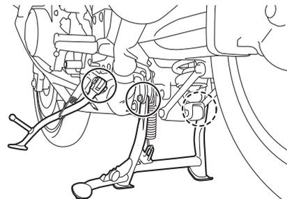
Die Funktion des Haupt- und Seitenständers sollte vor jeder Fahrt geprüft werden und die Drehpunkte und Metall-auf-Metall-Kontaktflächen sollten gegebenenfalls geschmiert werden.
