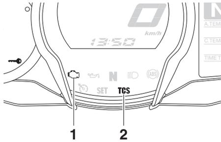
1. Motorstörungs-Warnleuchte "i" (Motor)
