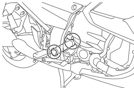
Die Schwingen-Drehpunkte müssen in einer Yamaha-Fachwerkstatt in den vorgeschriebenen Abständen geschmiert werden, gemäß der Tabelle für regelmäßige Wartung und Schmierung.
