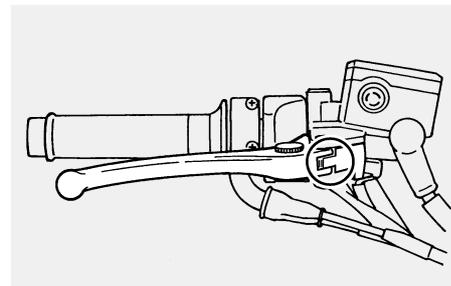
Vor Fahrtantritt die Funktion des Handbremshebels prüfen und ggf. den Drehpunkt schmieren.
