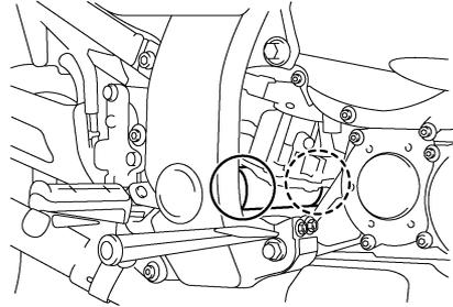
Die Schwingen-Drehpunkte müssen in einer Yamaha-Fachwerkstatt in den vorgeschriebenen Abständen geschmiert werden, gemäß der Tabelle für regelmäßige Wartung und Schmierung.
