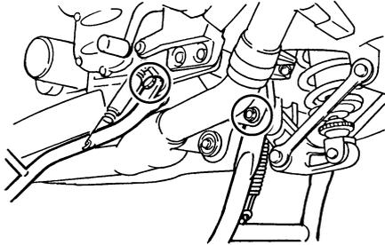
Die Funktion des Haupt- und Seitenständers sollte vor jeder Fahrt geprüft werden und die Drehpunkte und Metall-auf-Metall-Kontaktflächen sollten gegebenenfalls geschmiert werden.
